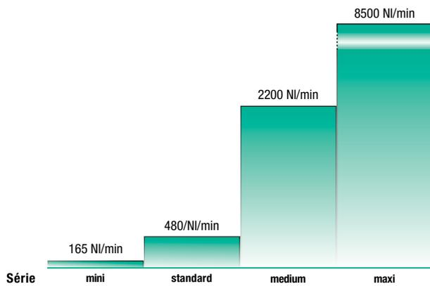
Mesures réalisées selon l'ISO 6358 à une pression de 6 bar, perte de charge < 0,7 bar (débit en simple obturation)
