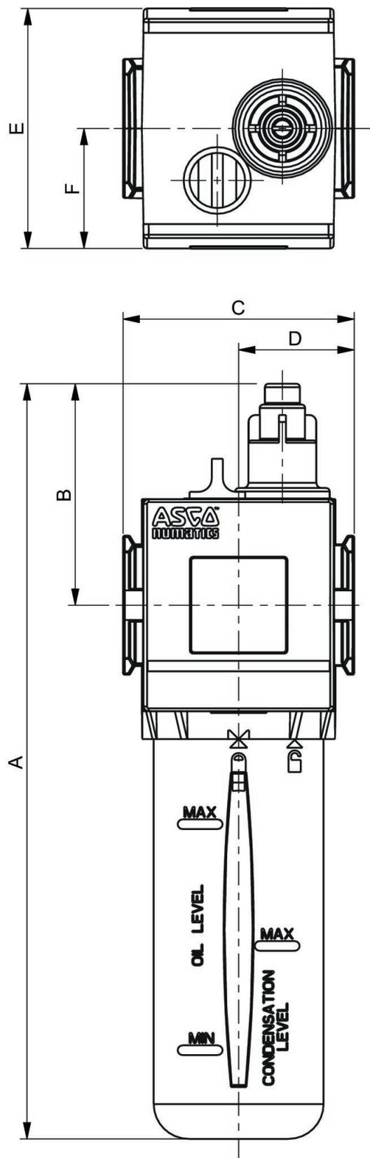
Pour retirer le bac, observer une distance de [[20] mm] au bord inférieur de l'évacuation du bac.
