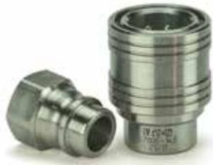
Le raccord rapide en acier inoxydable de la série L7000 Eaton est un raccord à passage intégral qui convient aux applications qui exigent une capacité de débit maximale et pour lesquelles aucun clapet n'est nécessaire. Principalement utilisé dans les applications de transfert de fluides et offre une excellente résistance à la corrosion.
