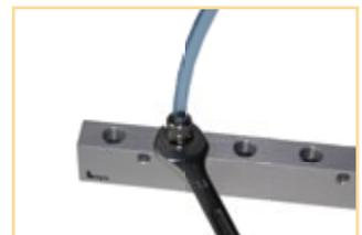
Visser l'écrou à fond, à la main (dans le cas d'un tube souple) et à la clé (dans le cas d'un tube semi-rigide) jusqu'au contact avec le corps.
