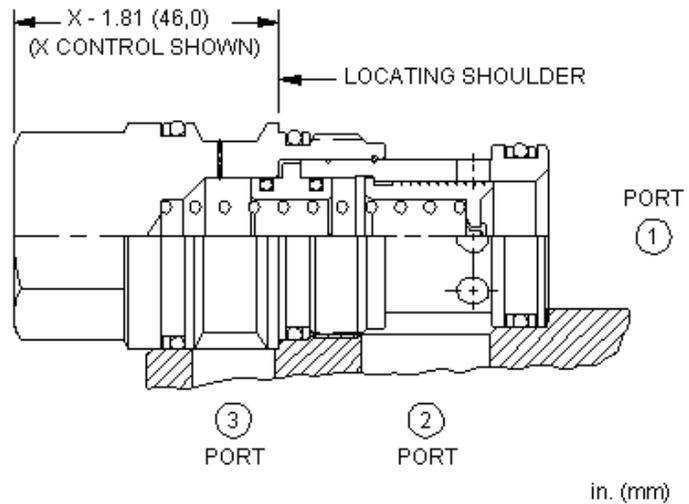
Cet élément de régulation normalement fermé sans gicleur interne est utilisé comme compensateur 3 voies pour maintenir une différence de pression constante à travers un étranglement, quelles que soient les variations de pression en amont ou en aval .
