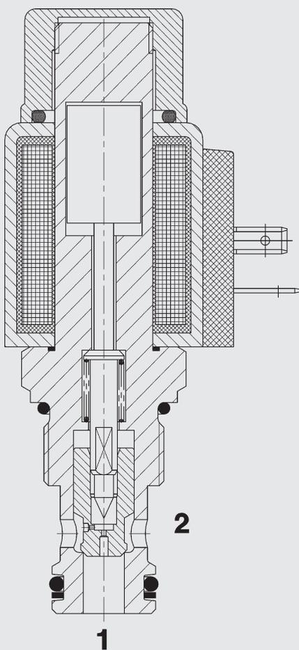
Lorsque le solénoïde n'est pas excité, le distributeur peut être traversé de l'orifice 2 vers l'orifice 1. Le distributeur ne peut pas être parcouru en sens inverse.
