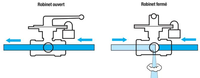
**Manette démontable** : en cas de montage du robinet le long d'une paroi, il est possible de démonter la manette pour la positionner dans le sens opposé au montage d'origine.
