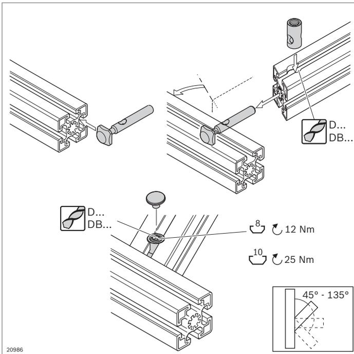
**Joint de serrage rapide pliable, face avant / Rainure**
