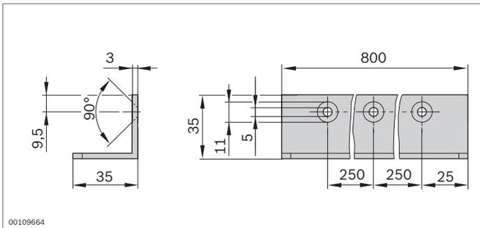
► Barre de butée, porte de système à monter soi-même
