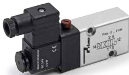
**Electrovanne de pilotage**, flasquée à l'actionneur pour créer un ensemble électropneumatique DC 24V, 2.5W Version 4/2 pour supporter simple et double effet. Protection IP65
