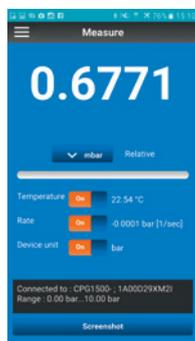
Au moyen de l'application "myWIKa device" et de la connexion WIKa-Wireless, le CPG1500 peut être configuré pour des routines d'étalonnage et d'enregistrement de manière conviviale avec un téléphone portable. Lors de la mesure de pression, la valeur est affichée dans l'unité requise directement sur le téléphone. En outre, d'autres paramètres comme le taux de changement de la température et de la pression peuvent être contrôlés.
