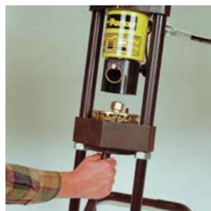
4. Engager l'embout à sertir dans la machine par le dessous.
