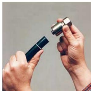
1. Marquer la longueur d'emboîtement de la jupe sur le tuyau. Engager l'embout sur le tuyau jusqu'à cette marque. Lubrifier si nécessaire.
