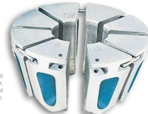
Les segments d'un même jeu de mors sont montés en chapelet et repérés en couleur. Cela assure un sertissage concentrique et une meilleure longévité des flexibles.
