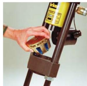
3. Mettre le jeu de mors en place en veillant à ce que les segments soient bien positionnés sur le séparateur.
