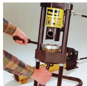
6. Remettre le poussoir en position et le verrouiller avec la goupille. Pomper ensuite jusqu'à ce que l'anneau de réglage vienne en butée sur la plaque de base.
