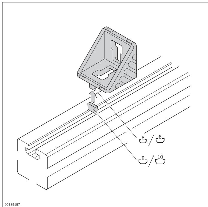
**Remarque:** Avec les vis d'assemblage, les équerres se montent de manière particulièrement simple et rapide (p. 3-5)
