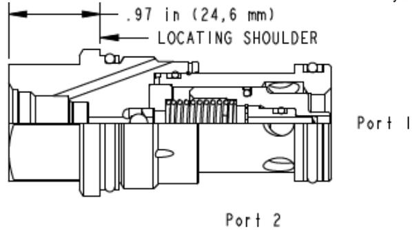
Cette valve est une cartouche 2 voies /2 positions à clapet qui intègre une cavité destinée à une valve de pilotage. Elle contrôle le débit depuis l'orifice 1 vers l'orifice 2, affiche des taux de fuite extrêmement bas et accepte 350 bar (5000 psi) sur ses 2 orifices. En installant une électrovalve de pilotage dans sa cavité T-8A on obtient un distributeur de grande capacité. Les autres options de pilotage comprennent des cartouches à commandes manuelles, hydrauliques et pneumatiques.
