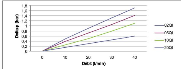
EPF Taille 1 Éléments filtrants avec valve de débit inverse
