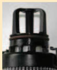
Une nouvelle conception brevetée de l'élément filtrant permet d'intégrer la valve de bypass et l'ame centrale supportant l'élément filtrant comme des pièces réutilisables dans le bol. Cela permet de réduire les coûts lors de l'intégration du filtre haute pression dans les blocs forés. Mais cela diminue aussi les déchets de plus de 50 % lors du changement de l'élément filtrant puisque l'ame centrale de l'élément fait partie intégrante du bol.
