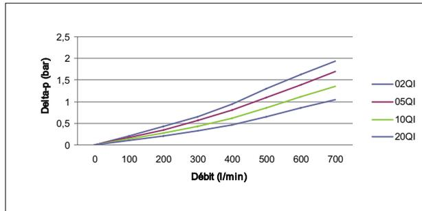
EPF Taille 5 Longueur 1 Éléments filtrants avec valve de débit inverse
